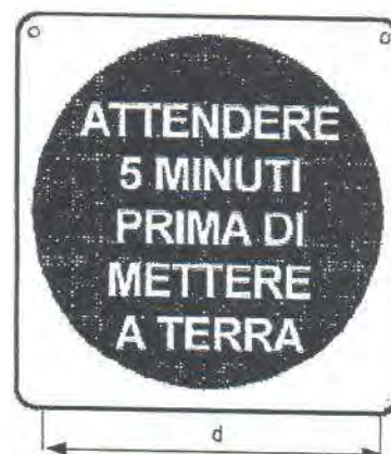
d = 260 mm altezza caratteri 20 mm
